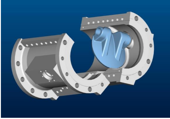
Şekil 7- İki Parçalı Alüminyum Gövde ve Klapeler, Katı Model
