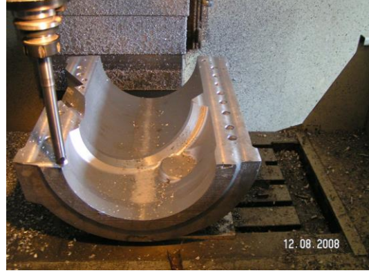
Şekil 8- Gövde Yarısının CNC Dik İşleme Tezgahında İmalatı
