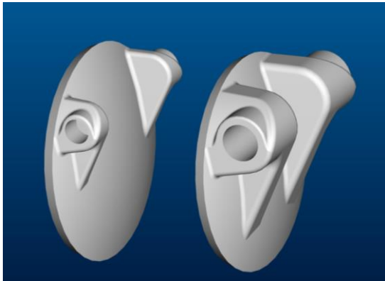
Şekil 9- (i)Klapeden ve (ii)Milden Frenli Olarak Tasarlanan Klapelerin Katı Modelleri
