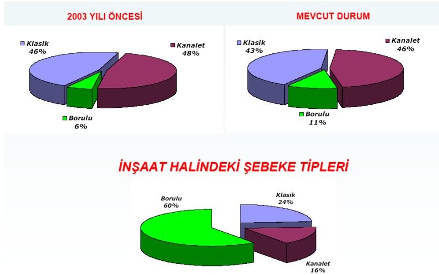
Şekil 7- İşletme ve İnşaat Halindeki Sulama Şebekesi Tipleri [5]
