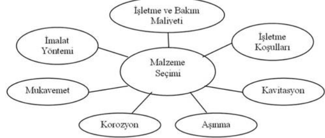
Şekil 6. Malzeme seçimine etki eden parametreler.
