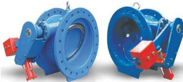
Şekil 3. Açılı sitli veya eğik oturaklı çek valf, strok sonu etkili hidrolik fren ile.
