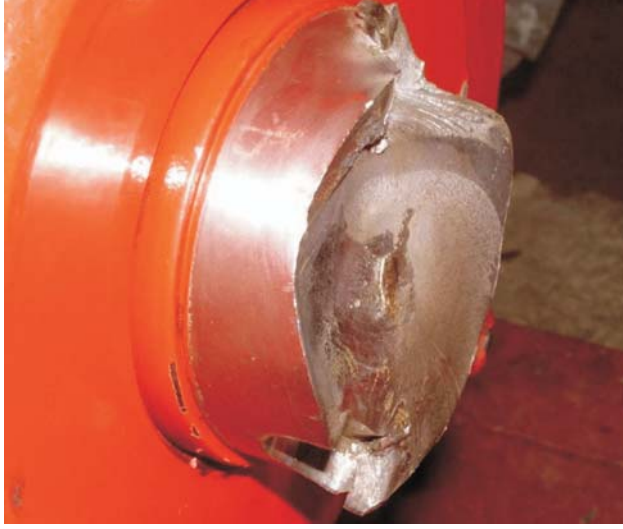
Şekil 5. Hizalama hatası sonucu 120 mm çapındaki milde yorulma kırılması.
