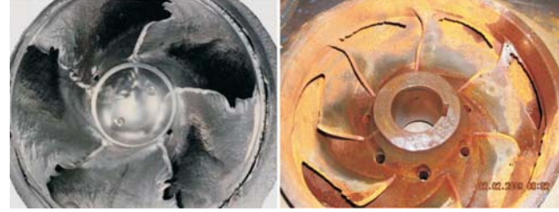
Şekil 3. Kaviteasyonla aşınan östenitik-ferritik paslanmaz (sol) ve pik döküm (sağ) çark.
