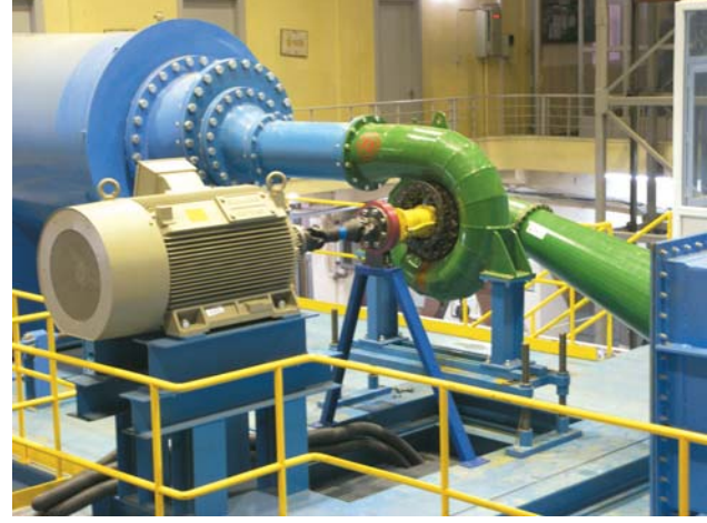
Şekil 5. Testi yapılan türbin, motor-generatör ve tork sensörü.
