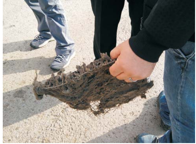
Şekil 5. Tuzla İleri Biyolojik Atıksu Arıtma Tesisi Ana Terfi Merkezi'ne gelen ipliksi malzemeler.
