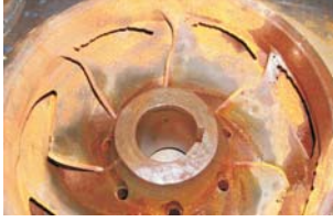
Resim 2. Kaviteasyon sonucu hasara uğramış çark.
