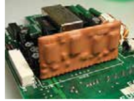
Şekil 2.1. PCB üzerinde epoksi ile enkapsüle edilmiş kart ve elektronik parçalar
