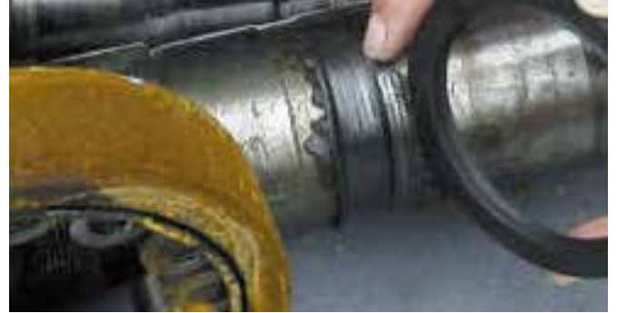
Şekil 2.2. Yağ keçesinin neden olduğu mil veya mil burcu aşınması
