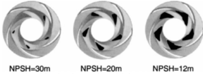
Şekil23. Fluent ile hesaplanan kavitasyon kovuğu bölgeleri
