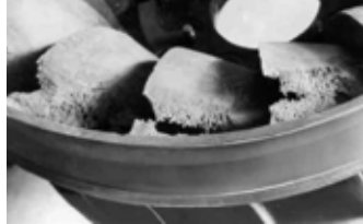
Şekil 9. Bir francis türbininde kaviteasyona bağlı malzeme kaybı
