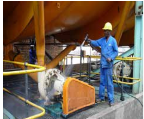
Şekil 2.1. Fabrikalarda ekipmanların basınçlı su ile yıkanması nedeniyle rulman yatağına su girmesi
