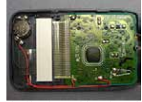
Şekil 2.1. PCB üzerinde epoksi ile enkapsüle edilmiş kart ve elektronik parçalar
