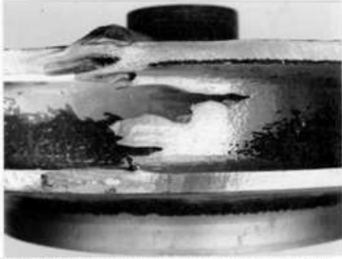
Şekil-6: Çark çıkışında meydana gelen erozyon[4]
