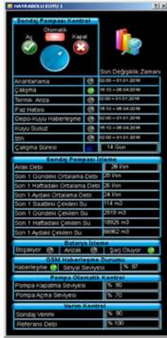
Şekil 13- SCADA Örnek Derin Kuyu Kontrol-Takip Ekranı (TESKİ)
