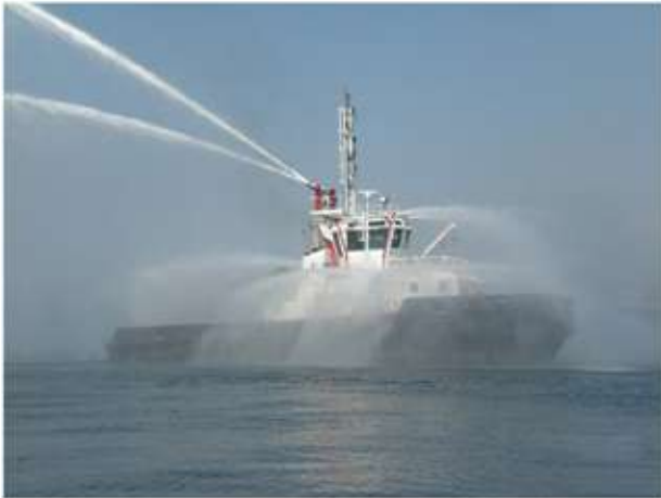
Şekil 2.1 Bir geminin su topu operasyon testi
