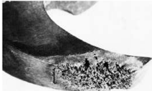
Şekil-5: Çark çıkışında meydana gelen kaviteasyon korozyonu[4]
