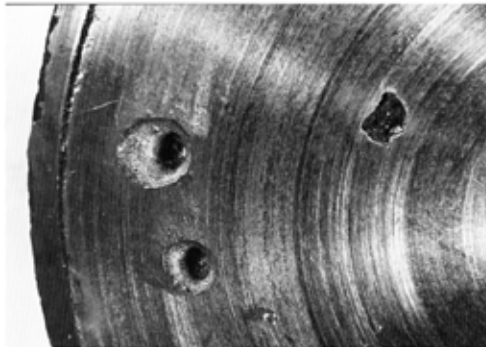
Şekil-2: Çark üzerinde meydana gelen pitting korozyonu [4]
