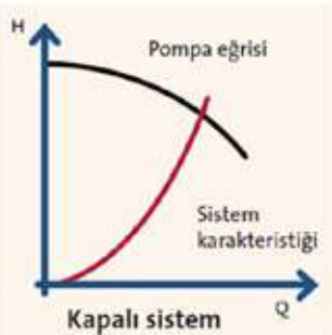
Grafik 1: Pompa eğrisi ve sistem eğrisi
