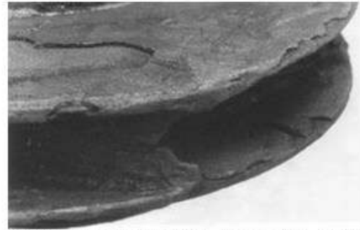
Şekil-1: Gri dökme demir malzemeden oluşan santrifüj pompa çarkında grafit korozyonu[10]
