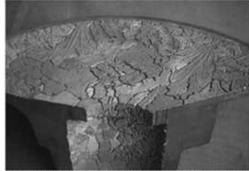
Şekil-4: Taneler arası korozyon meydana gelmiş santrifüj pompa salmastra yatağı [1]
