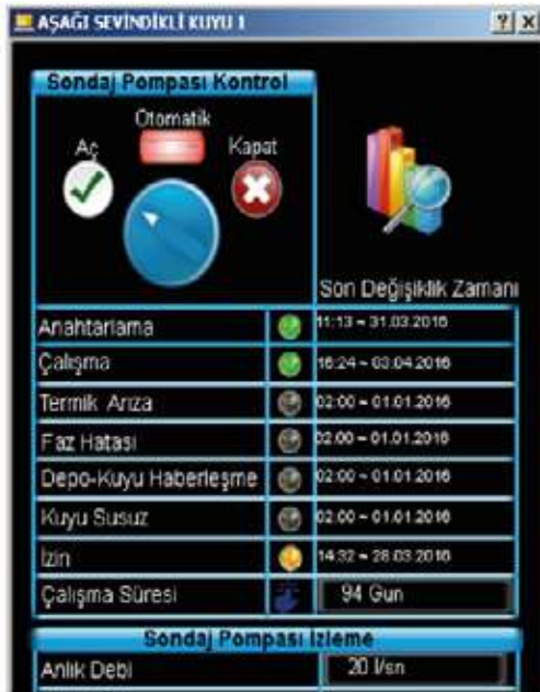
Şekil 7- SCADA Derin Kuyu Motor-Pompa takip ekranından bir görüntü (TESKİ)
