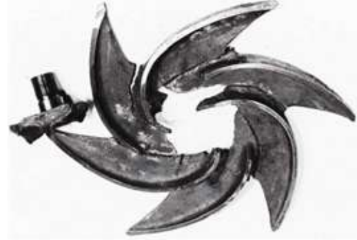
Şekil-7: Gerilmeli korozyona maruz kalmış santrifüj pompa çarkı[4]
