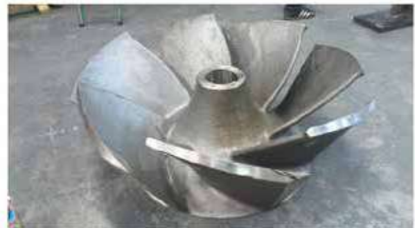
Şekil 4.5 İmalatı tamamlanan pompanın çarkı
